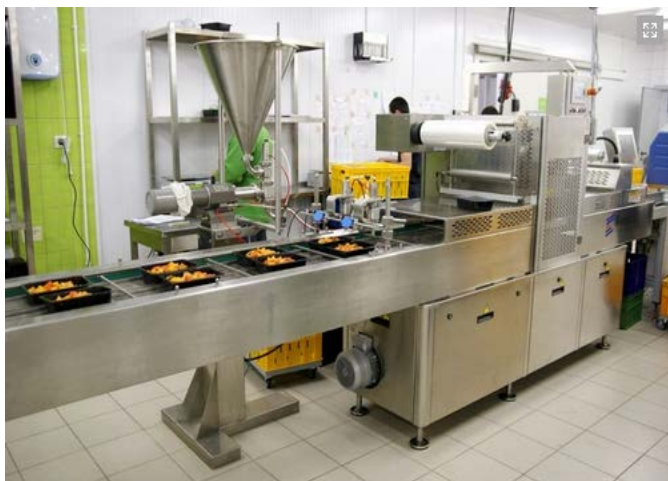
Рис. 2 Процесс упаковки продукции в индивидуальные барьерные лотки:
