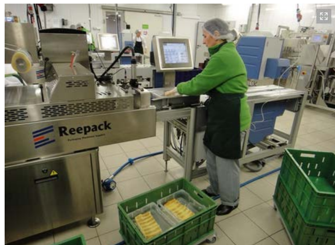
Рис. 2 Процесс упаковки продукции в индивидуальные барьерные лотки:
