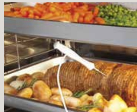
Контроль температуры продукта с помощью щупа, который входит в стандартную комплектацию.
