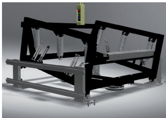
Система фронтального и заднего опрокидывания для упрощения процесса загрузки и разгрузки белья в машинах с большой вместимостью (60 и 120 kg). / Front and back tilting system for an easy and quick loading / unloading in big capacity machines (60 and 120kg).
