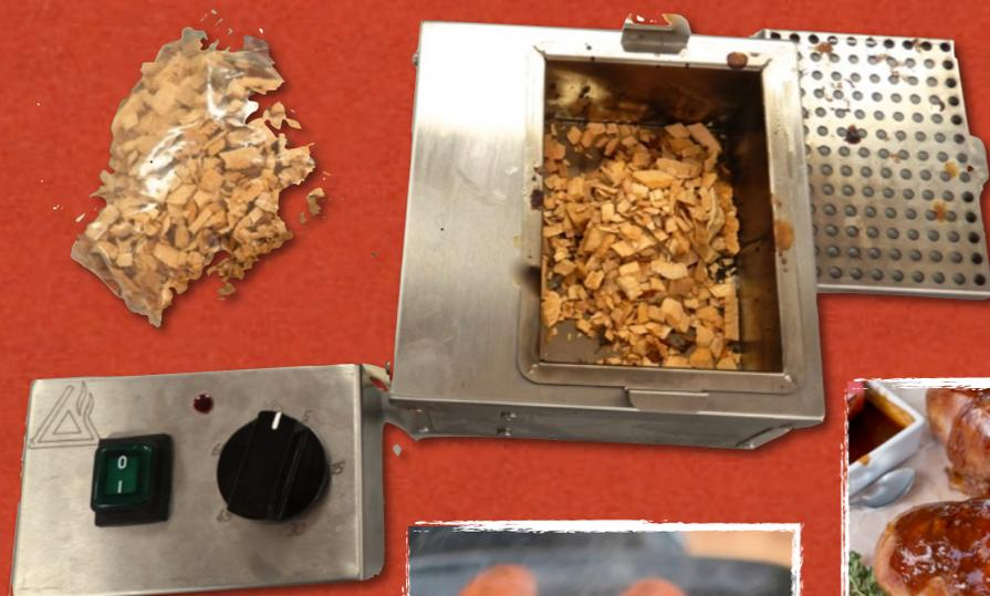
*Блок дымогенератора 200x210x120мм.
