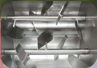
Вид изнутри. Ворошители из нержавеющей стали
