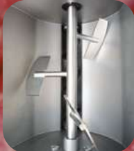
Фаршемешалка. Ворошитель из нержавеющей стали
