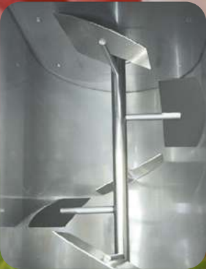
Вид изнутри. Ворошитель из нержавеющей стали
